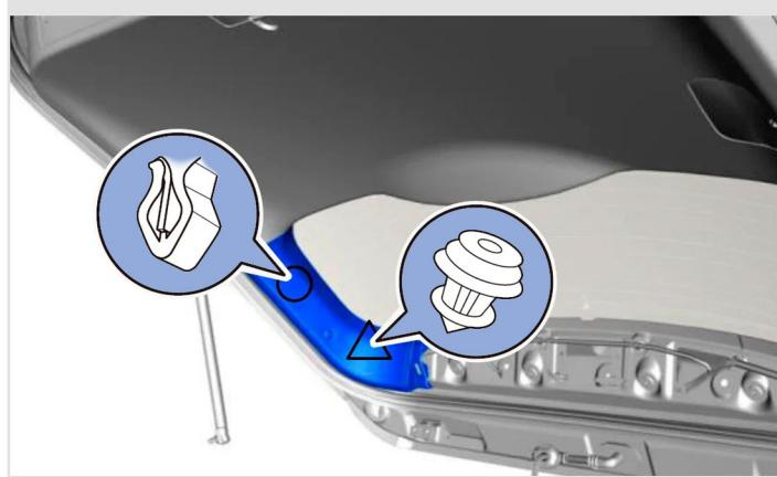
**3** Откройте **заглушки** саморезов крепления нижней обивки двери багажного отделения, затем открутите **семь саморезов** крепления нижней обивки двери багажного отделения.
